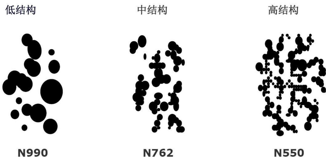
图 1.3.1 N990, N762, N550 的结构比较（注：图中炭黑粒径不成比例）
